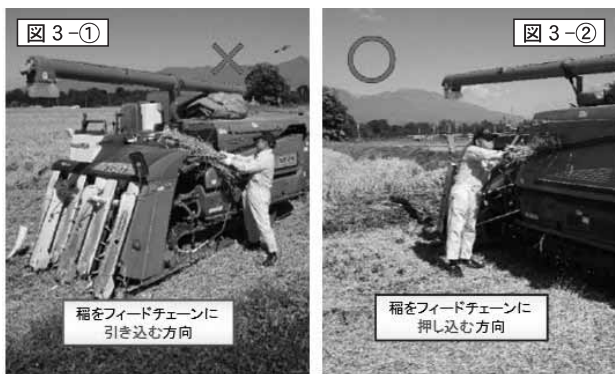
手こぎをする場合、左のようにフィードチェーンに引き込む方向では、手も一緒に引き込まれる。右のように、フィードチェーンに押し込むようにすると、巻き込まれにくい。
